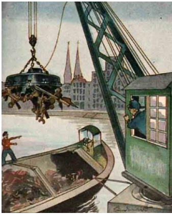
Abbildung 2: Schrott wird mithilfe eines Elektromagneten verladen.
