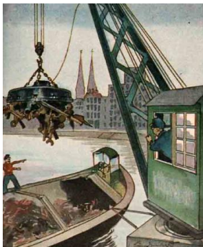
Abbildung 1: Schrott wird mithilfe eines Elektromagneten verladen.
